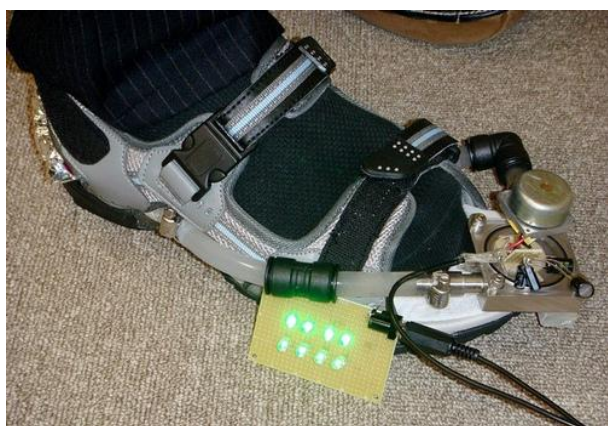
圖 2-1-1、日本電信電話公司 NTT 研製的充電鞋
