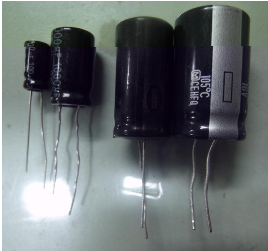
圖 4-2-4、作為儲存電能的傳統電解電容
