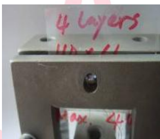
圖 4-2-1-7 線圈置於門型框中
