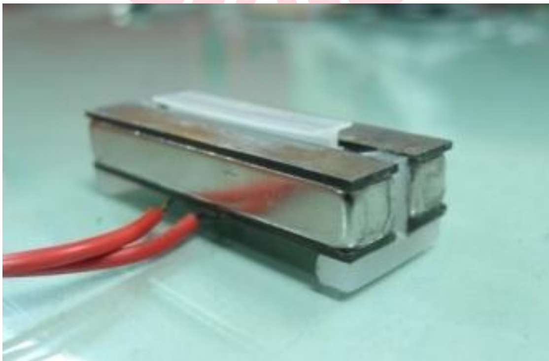
圖 3-3-3、震動式片狀發電機實品
