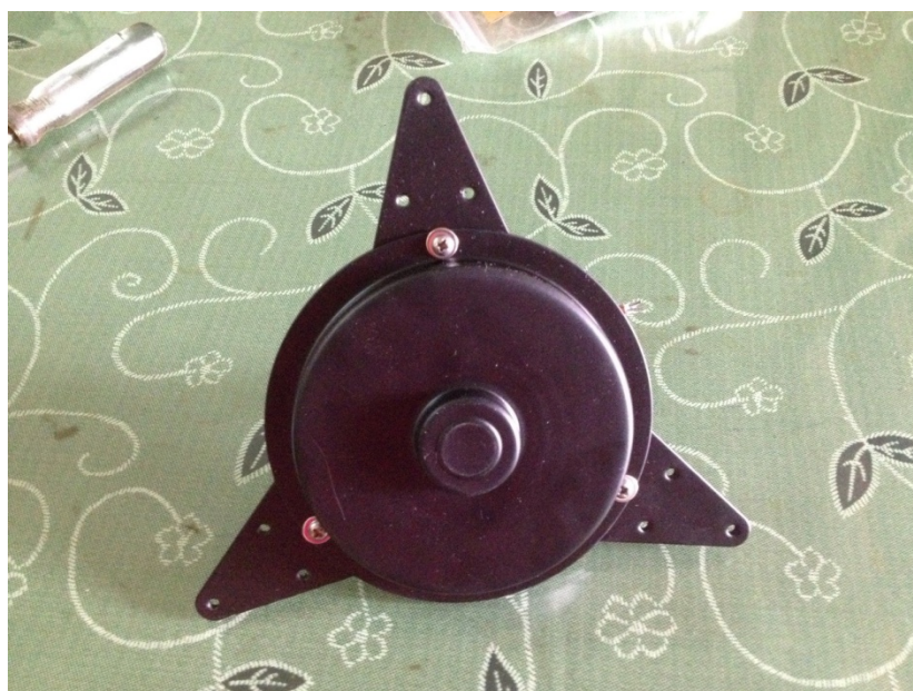
(圖 10. 30W 風力發電機)
