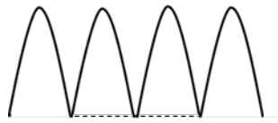
圖 12、全波橋式整流電路正負半週的波形圖
