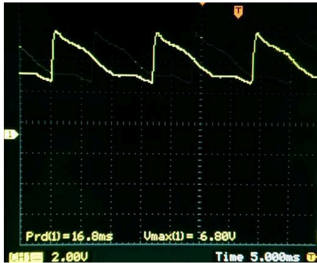
圖 17、三角波產生電路的波形圖
