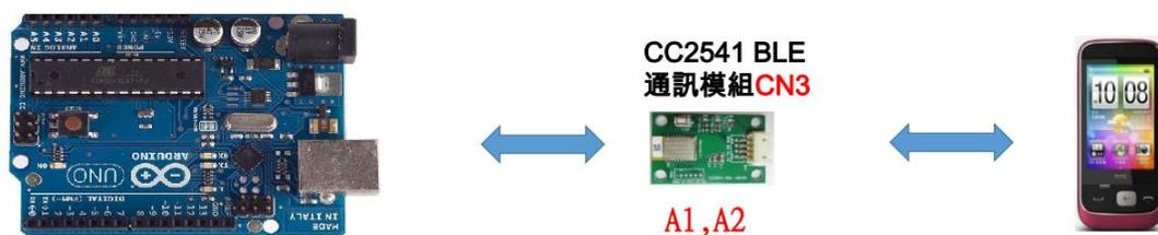
圖 3.2 Arduino 架構圖
