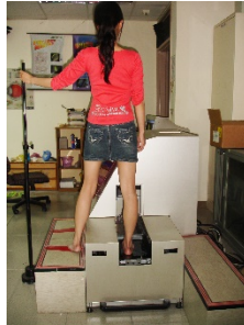
圖 4 量測 95%體重荷重在右腳的情形。受測者右腳踩放在量測平台上頭，左腳腳跟微微抬高，讓體重集中在右腳。
