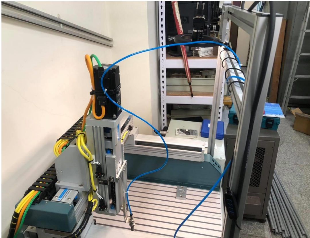
圖 6-4 氣壓帶動真空吸盤吸盤
