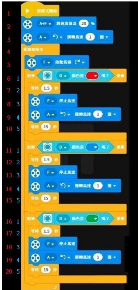
圖 5-10 主機 a 程式 (輸送帶裝載機、輸送帶 A)
