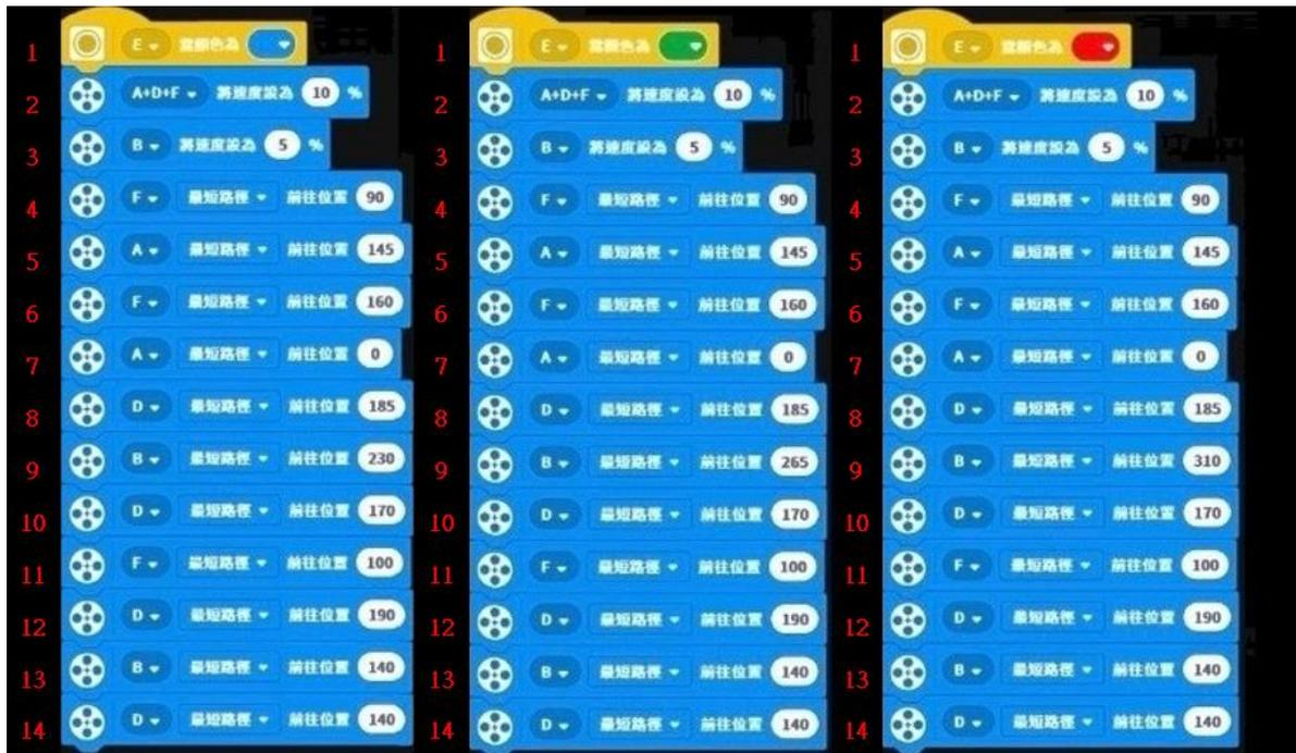
圖 5-23 主機 e 程式 (機械手臂 B)
