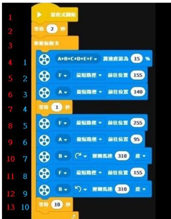
圖 5-12 主機 b 程式 (機械手臂 A)
