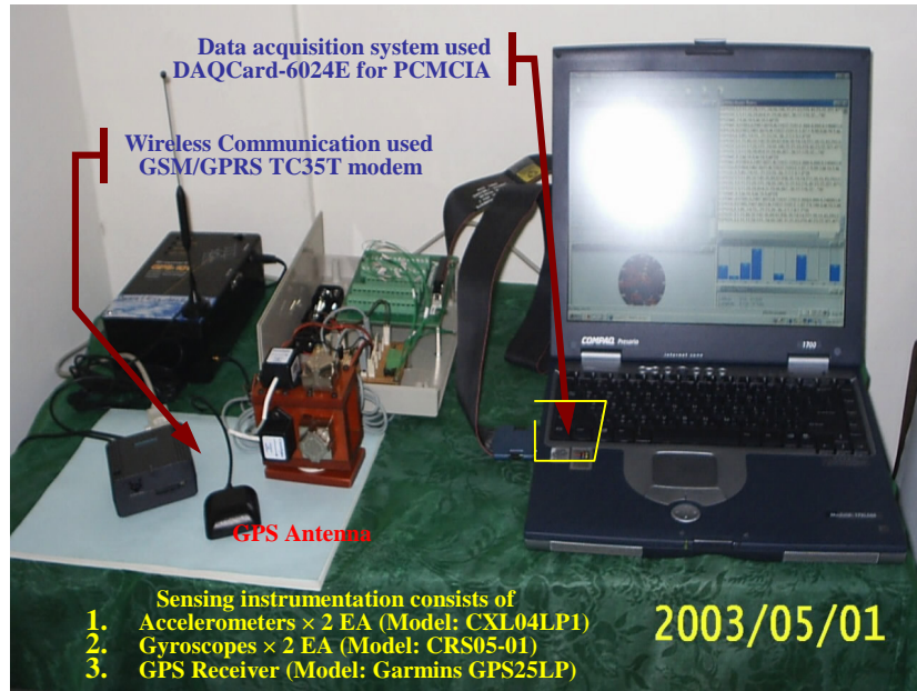
圖四：整合型 GPS/INS 非線性導航實體架構(含 GPS 接收器 GSM 模組、加速規/陀螺儀、DAQ 擷取卡及 RS232 等)
