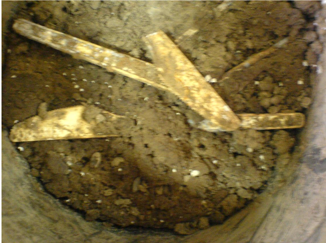
圖 10.d、聚乳酸餐具組分解第 27 天之外觀。 微生物分解餐具速度加快，餐具出現自然斷裂。
