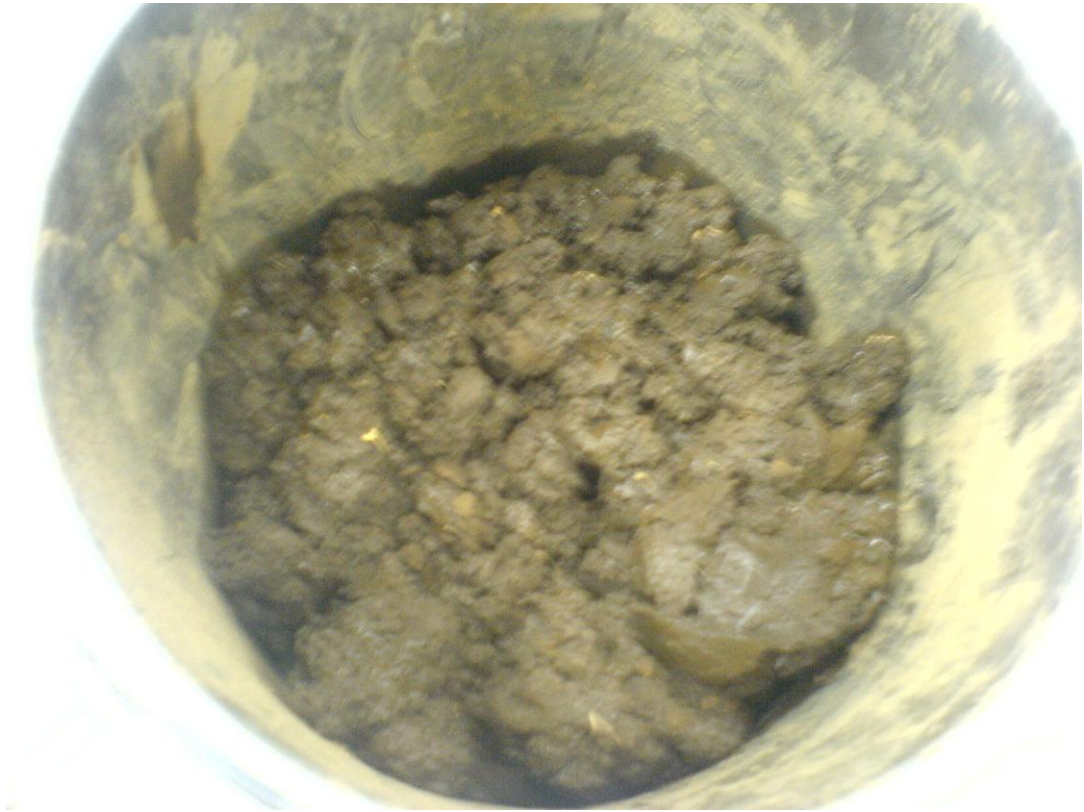
圖 10.h、聚乳酸餐具組分解第 119 天之外觀。 餐具完全分解。
