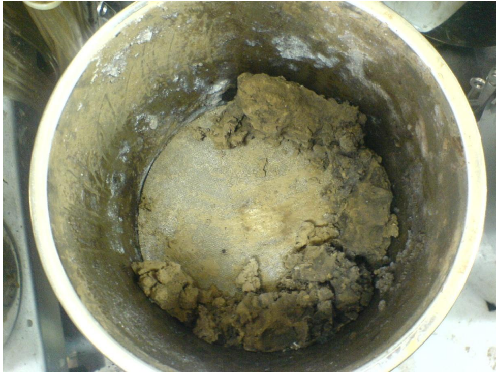
圖 9. g、聚乳酸發泡板分解第 79 天之外觀。
