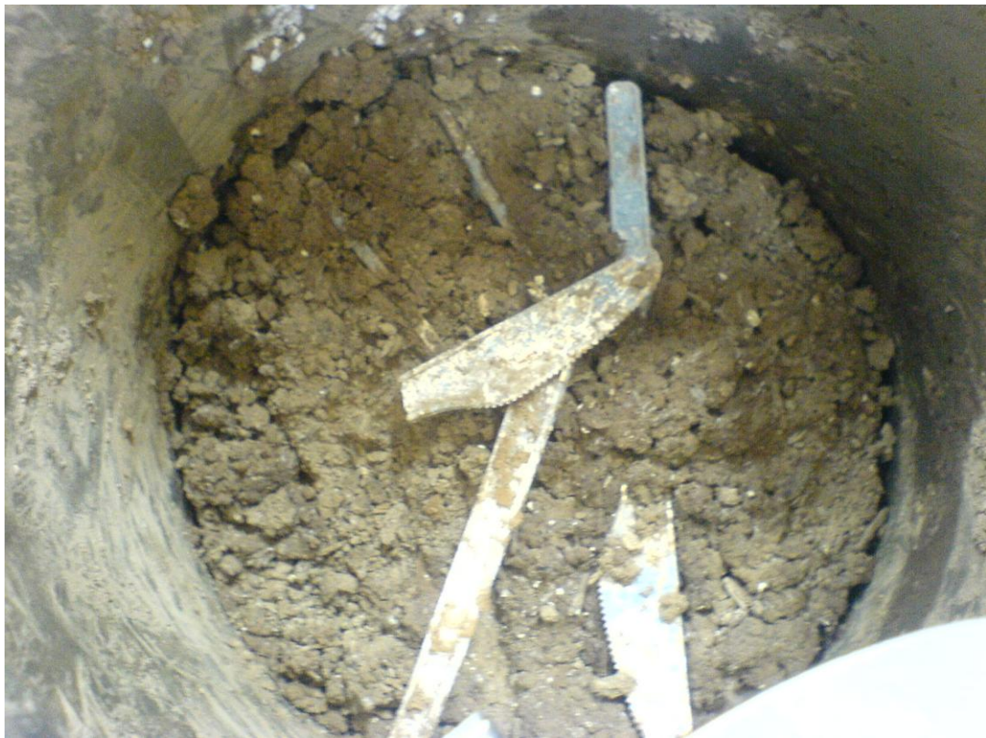
圖 10.e、聚乳酸餐具組分解第 42 天之外觀。 斷裂情況增加。
