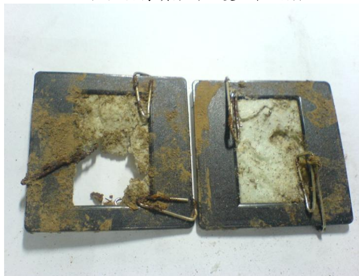
圖 11. f、第六週發泡板夾入幻燈片夾之外觀。 分解速度明顯增加，發泡板厚度變小。
