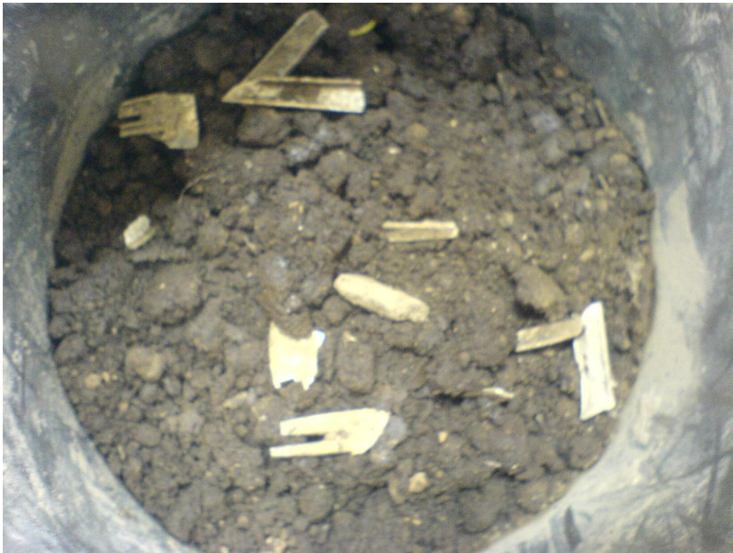
圖 10. g、聚乳酸餐具組分解第 98 天之外觀。 餐具剩較厚部位尚未分解。
