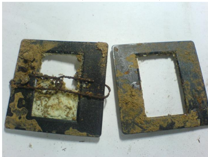
圖 11. h、第八週發泡板夾入幻燈片夾之外觀。 有部分發泡板分解完全。
