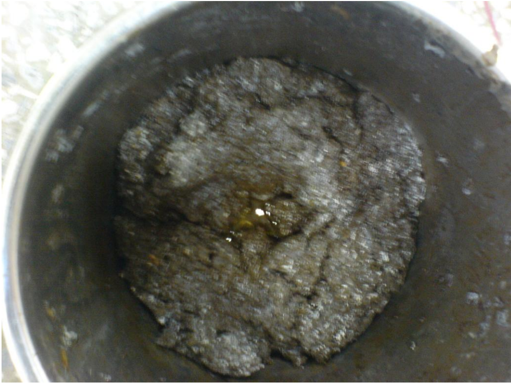
圖 9. e、聚乳酸發泡板分解第 29 天之外觀。
