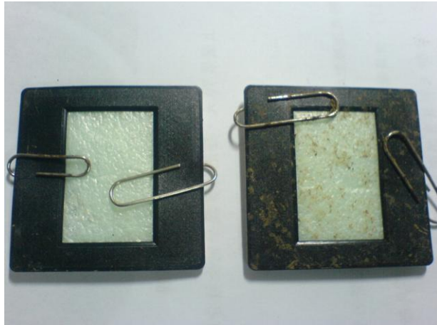
圖 11. a、第一週發泡板夾入幻燈片夾之外觀。 發泡板尚無變化。
