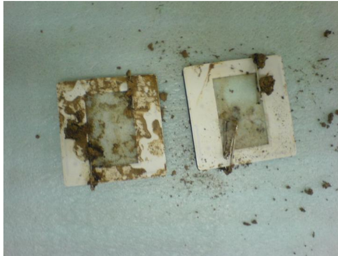
圖 11. g、第七週發泡板夾入幻燈片夾之外觀。 發泡板軟化無法完整依附在幻燈片上。
