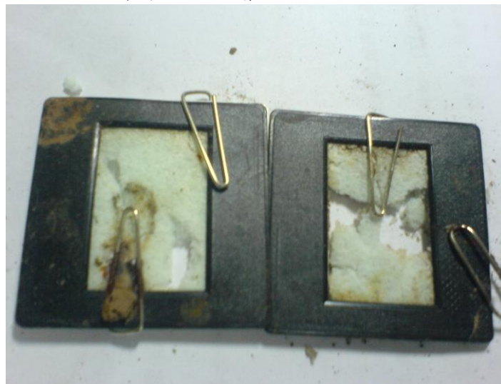
圖 11. e、第五週發泡板夾入幻燈片夾之外觀。 微生物持續分解，變化較明顯。
