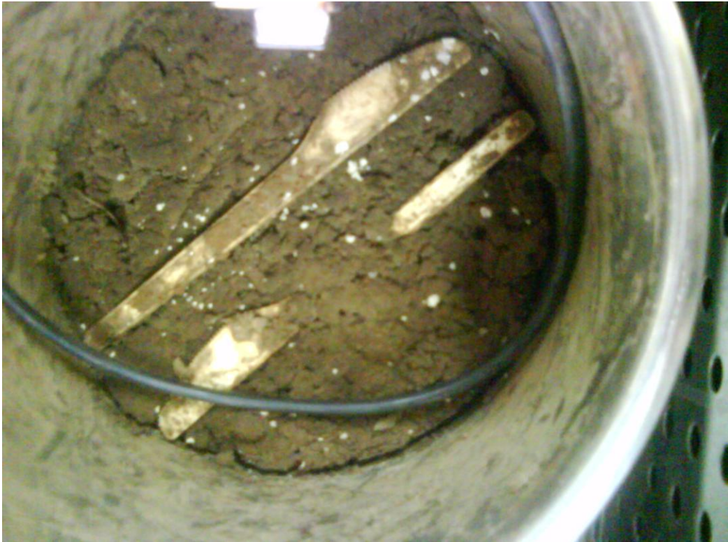
圖 10. b、聚乳酸餐具組分解第 14 天之外觀。 餐具顏色有點變化。
