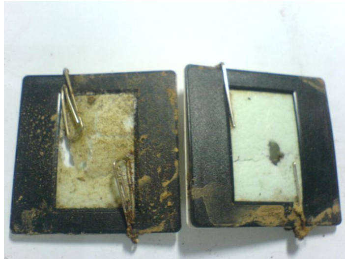
圖 11. d、第四週發泡板夾入幻燈片夾之外觀。 裂痕、破洞增加。
