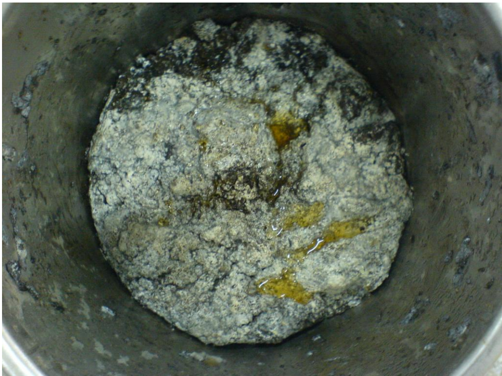
圖 9. f、聚乳酸發泡板分解第 36 天之外觀。
