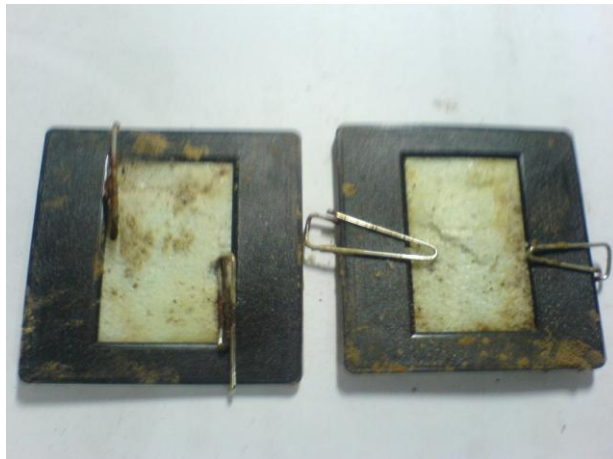
圖 11. b、第二週發泡板夾入幻燈片夾之外觀。 因發泡板表面有很多孔隙，所以很快出現裂痕。
