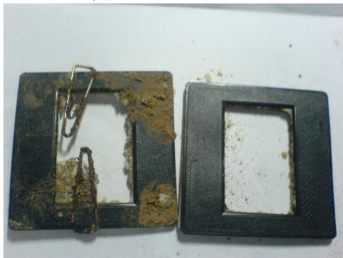
圖 11. i、第九週發泡板夾入幻燈片夾之外觀。 已完全分解。
