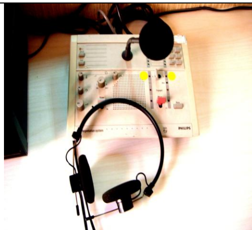
● 翻譯員在隔間內用耳機接收台上主講人所說的訊息後，再將已詮釋好的譯文透過麥克風告知給服務對象。除了這二項設備，還可以看到儀器上還有其他大大小小的音量控制鈕等鍵。
