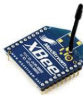
圖 11 XBee 模組
