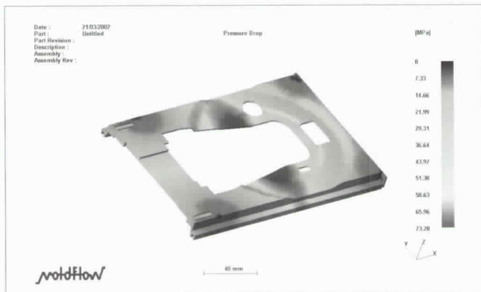
圖五、避免毛邊現象最差條件組合A1、B1、C3、D3之壓力分佈
