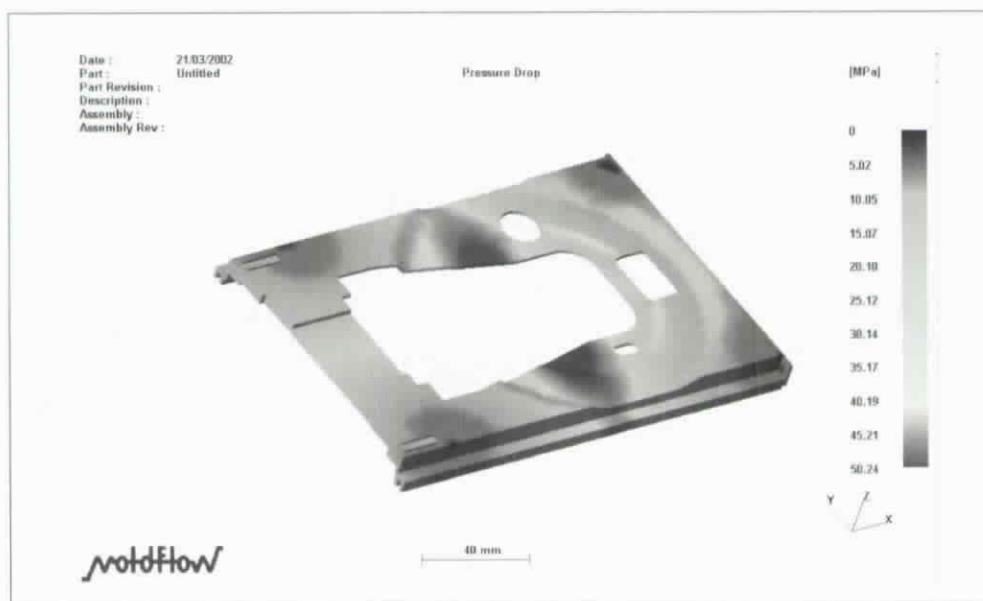
圖四、避免毛邊現象最佳條件組合A3、B3、C2、D1之壓力分佈
