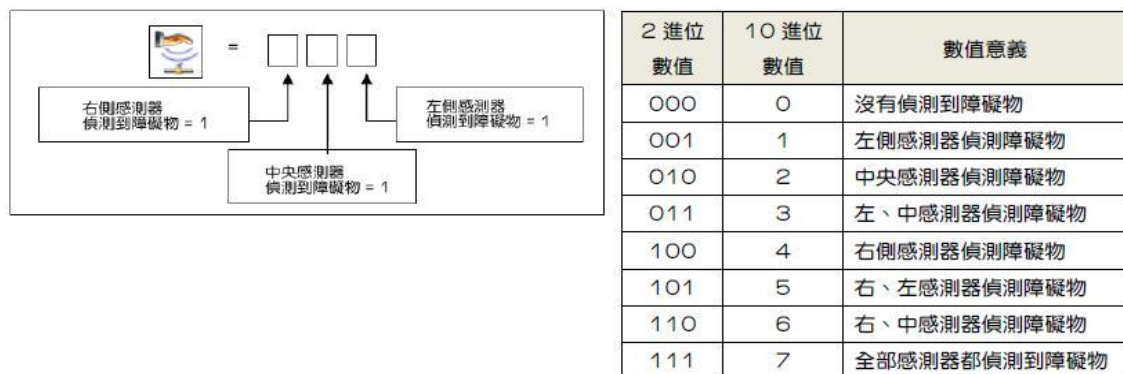
(圖2.1.11)障礙物判斷準則示意圖
