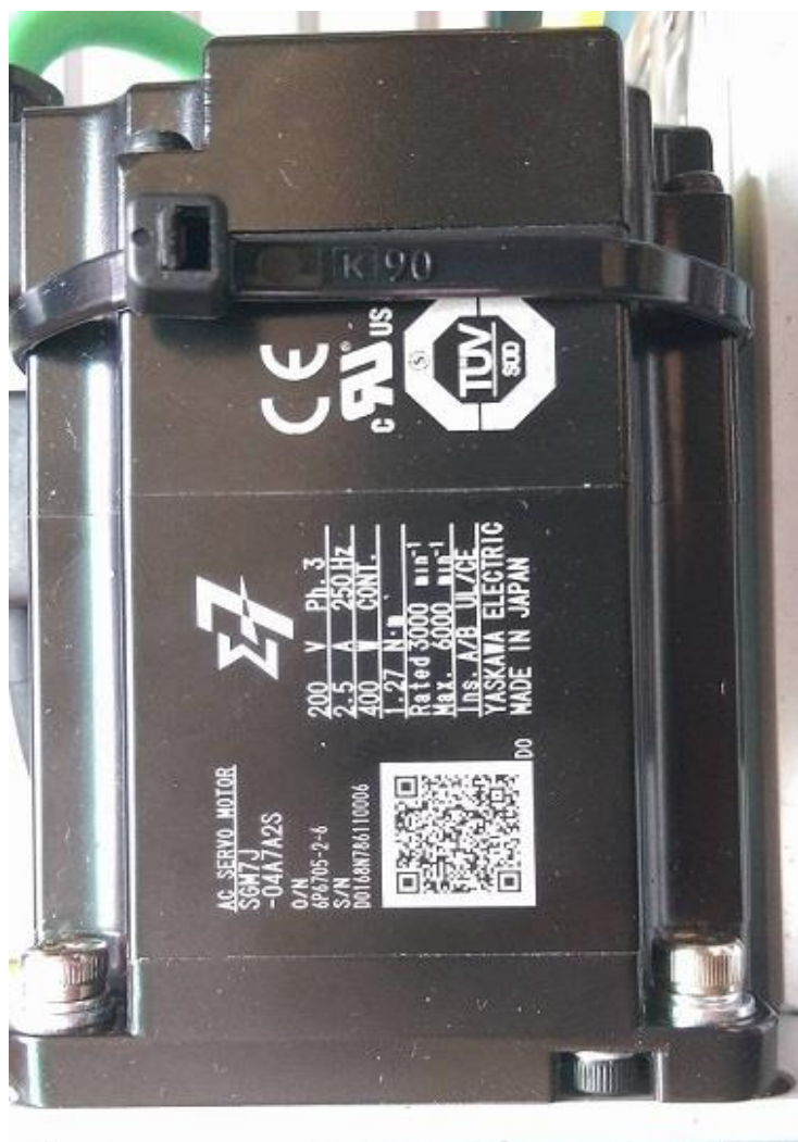
圖 2-2 伺服馬達 250hz 400w rated:3000 max:6000
