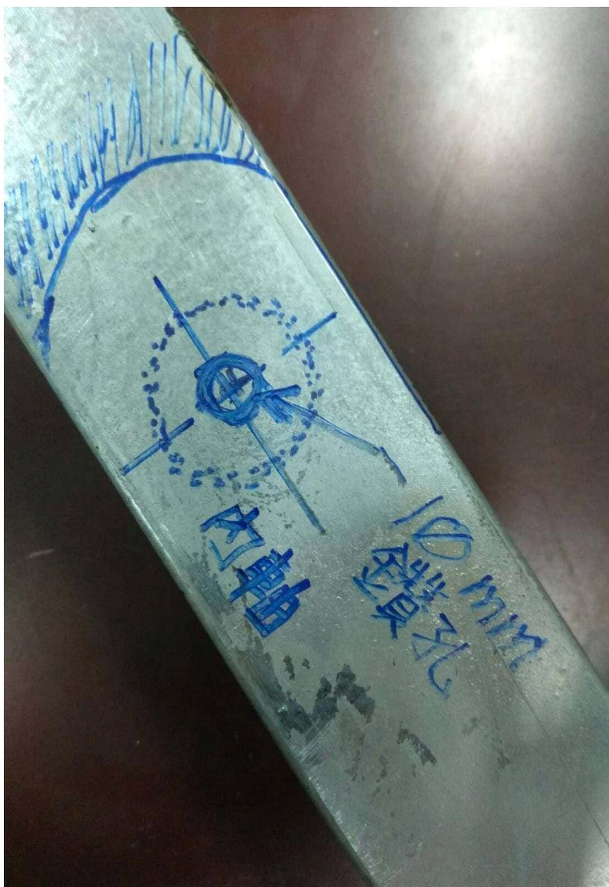
圖 2.3.1 前端切割、鑽孔位置繪製圖【4】
