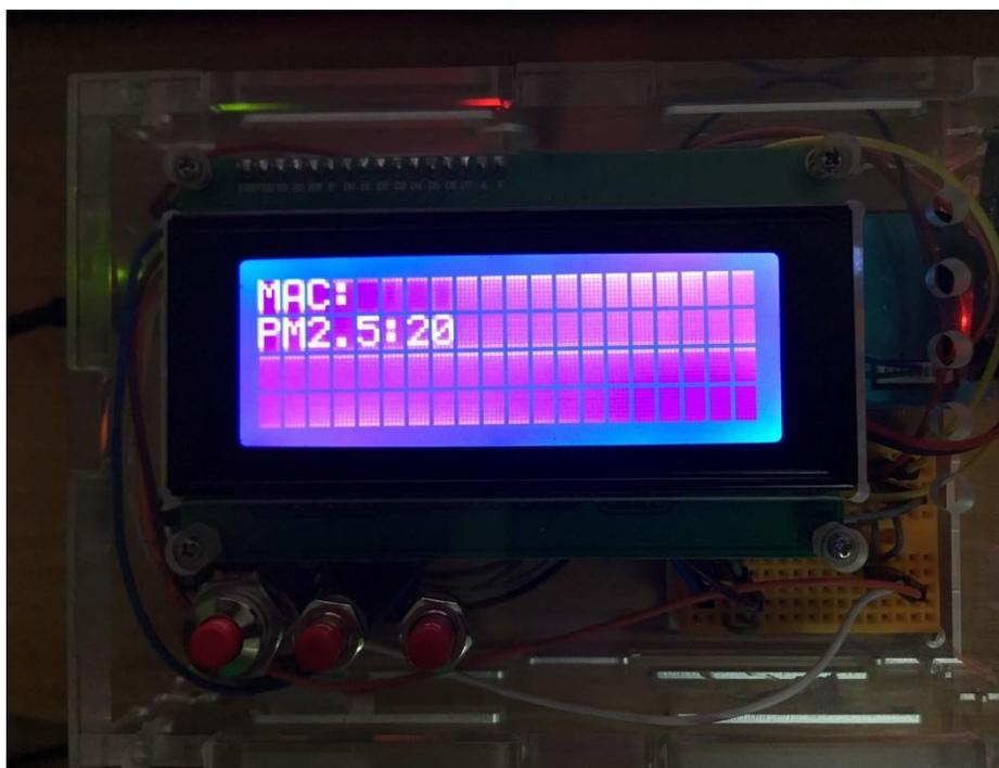
圖(3.2.4)PM2.5 感測器測試程式顯示在 LCD 畫面結果。
