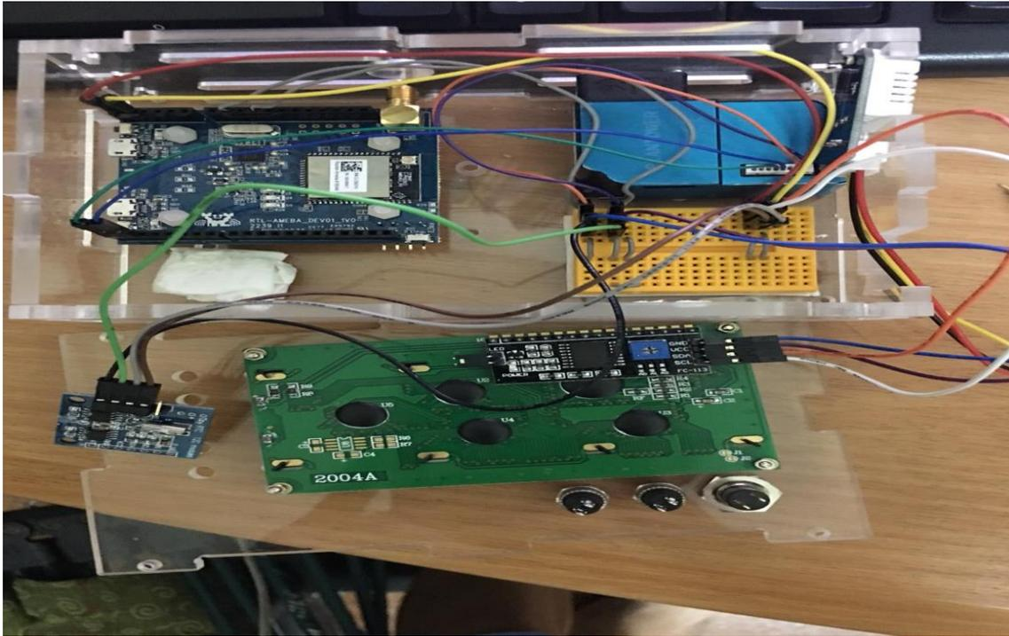
圖(3.1-3)安裝溫溼度感測器
