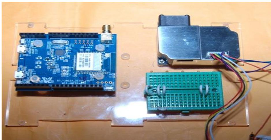
(圖 2.2-2) 安裝阿米巴開發板和 PMS3003 感測器
