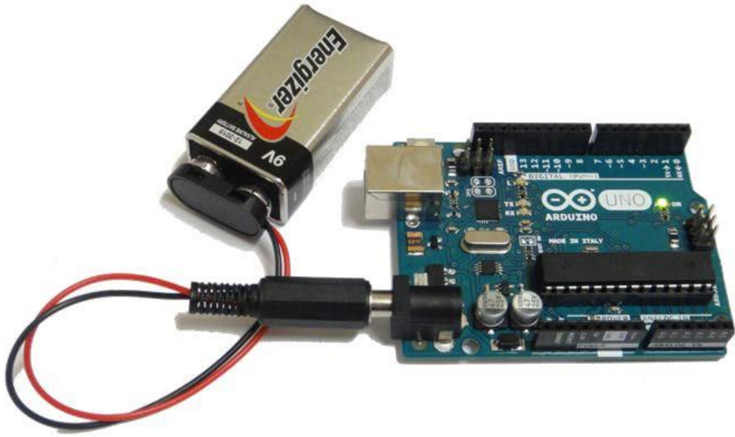
圖 2.5.3 使用電源輸入插座供電給 Arduino Uno
