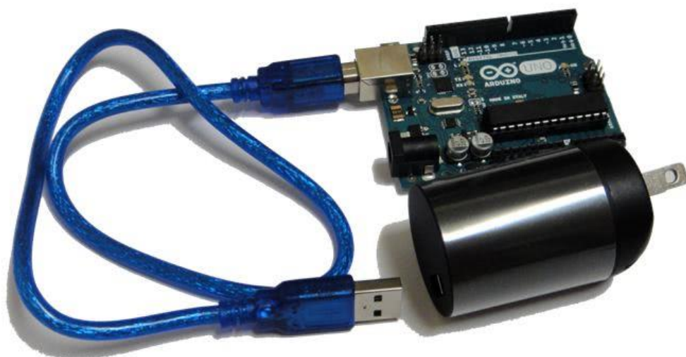
圖 2.5.2 使用 USB 供電給 Arduino Uno
