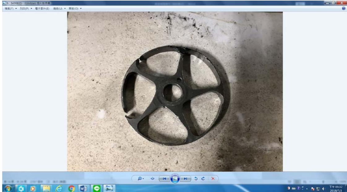
圖 3.3 齒盤模具壓板
