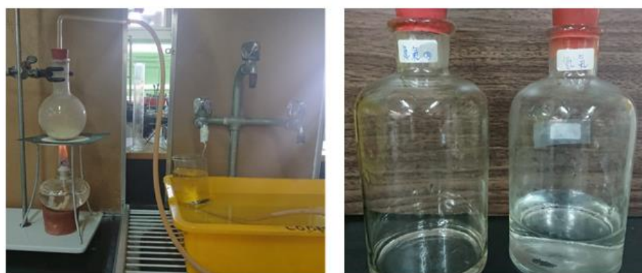
圖四：改善後的氮氣製取裝置
