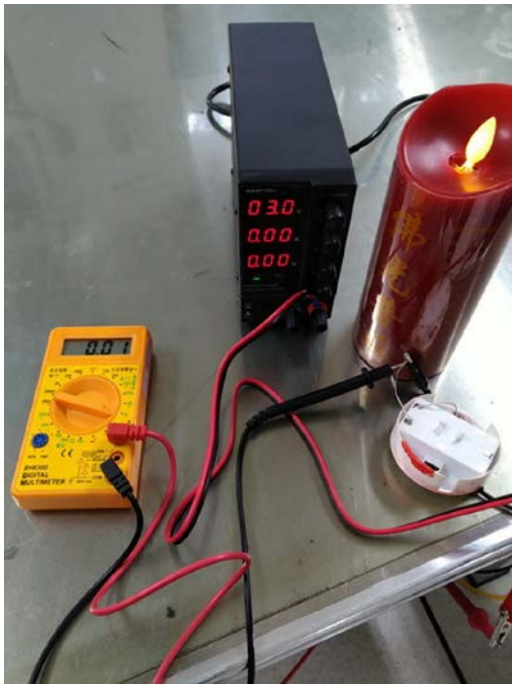
圖 3.2-1 3 V 時線路上的電流值量測 圖 3.2-2 USB 電源線製作與電壓量測
