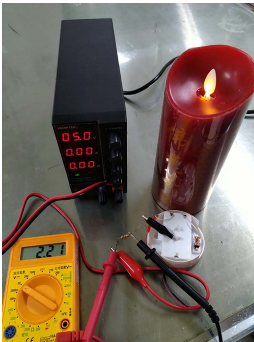
圖 3.2-3 串接 200\ \Omega 降壓電阻來試驗
