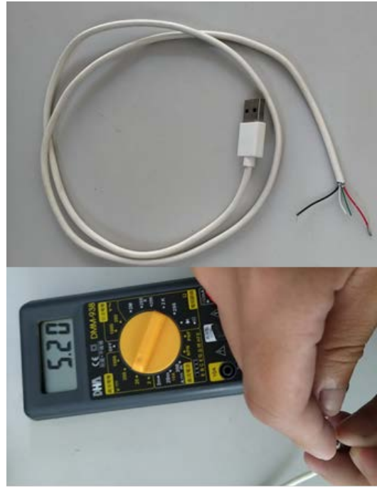
圖 3.2-1 3 V 時線路上的電流值量測 圖 3.2-2 USB 電源線製作與電壓量測
