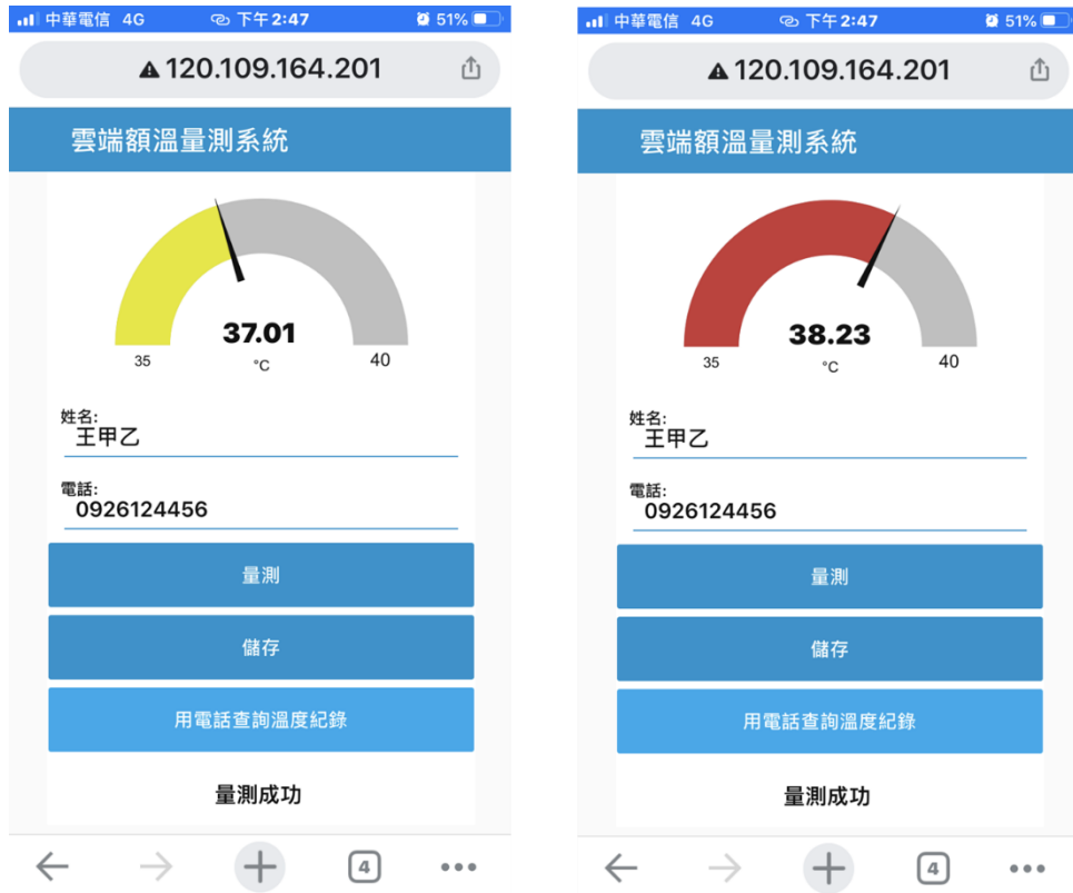
圖 5-17(a) 額溫量測在警戒範圍內；(b) 額溫量測出現重大事件
