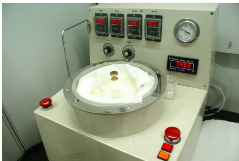
圖 3.2.1-2 使用旋轉機作為Spin coating (旋轉塗佈法)
