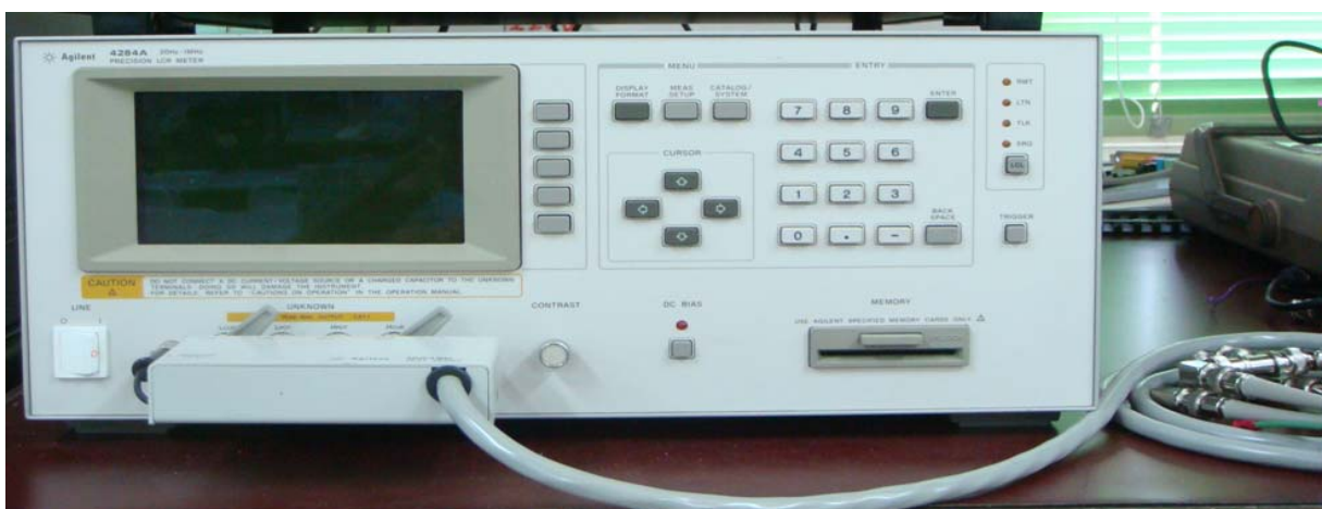
圖 3.3.7-1 本次實驗所使用的精密量測儀LCR
