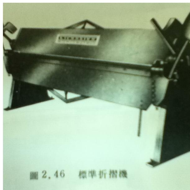
標準折摺機能由一人容易地操作，並可做快捷確實之調節，其折摺邊緣能更換，各部機件之設計及平衡。
