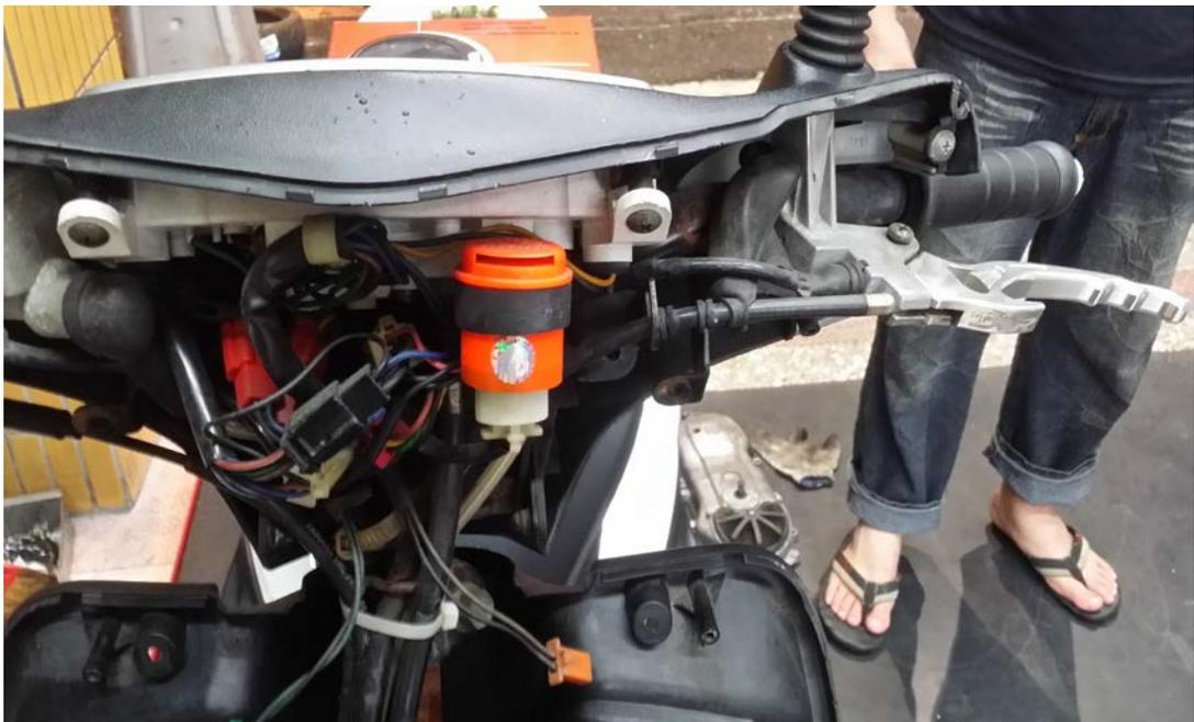
圖 22 原本舊式剎車系統移除
