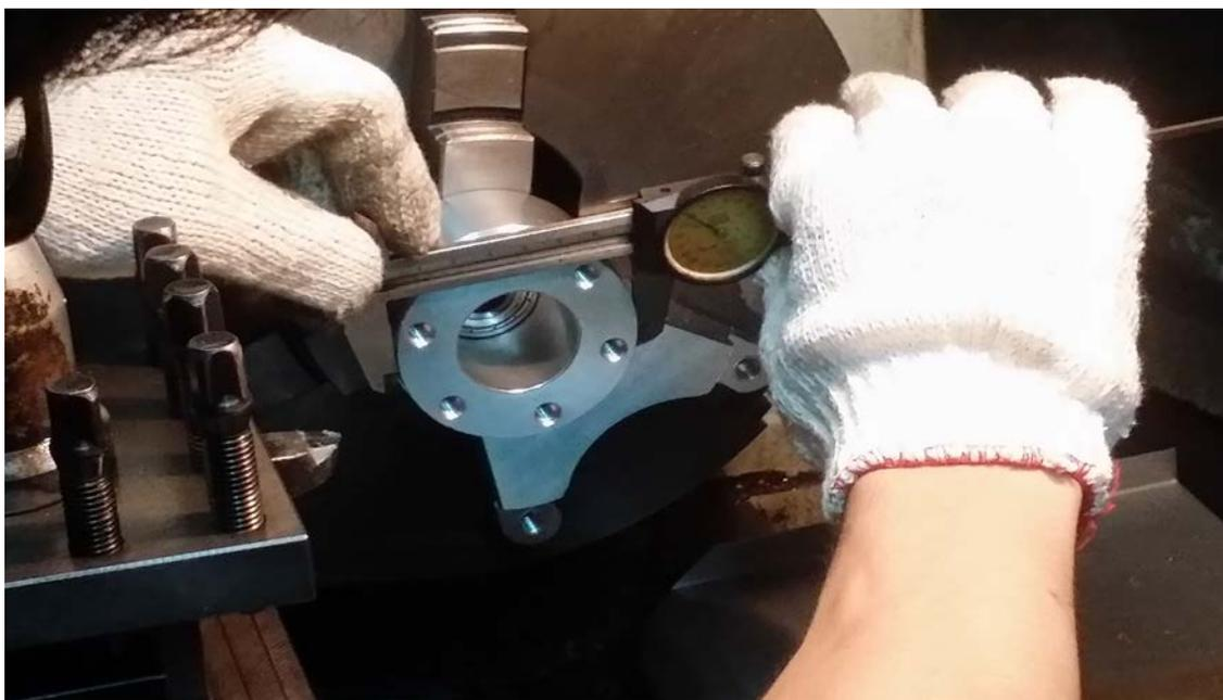
圖 8 測與設定須修改的尺度與長度
