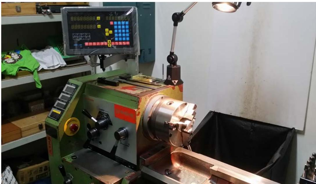
圖 6 此機台為本次專題中所使用的車削工具機
