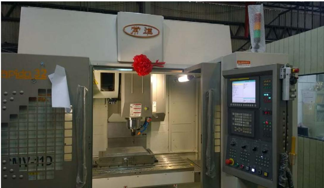
圖 2 這次所使用的常準 CNC 銑床
