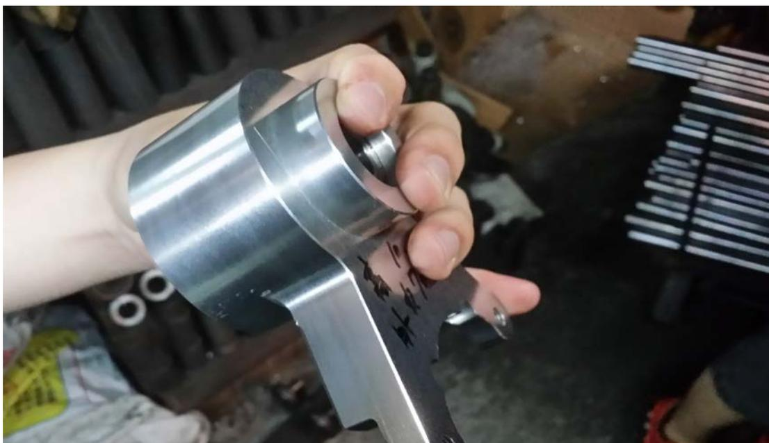
圖 7 一次加工出來的後卡鉗座成品，由於在上車測試時發現少計算到空間上的問題，所以要進行第二次的加工改良。
