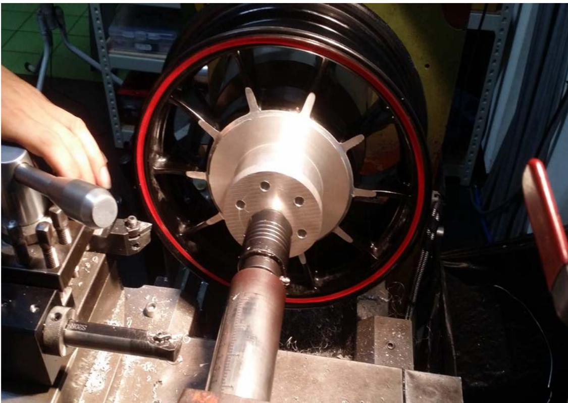
圖 14 後碟煞盤固定座與輪圈的結合
