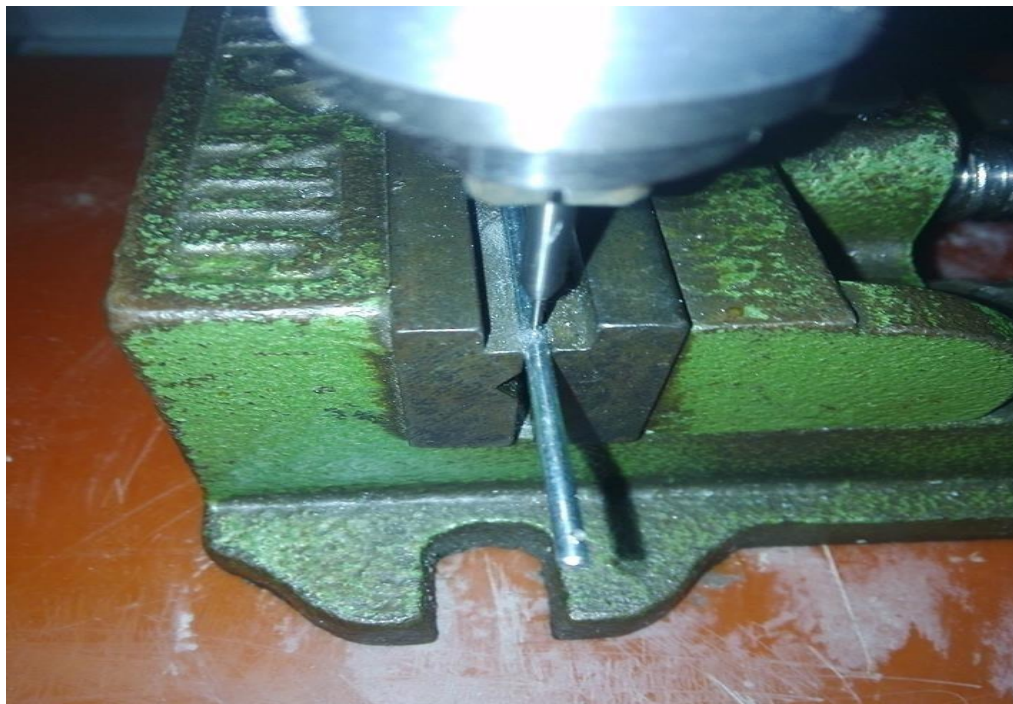
圖 5.11 軸心用雕刻機鑽 D1 的孔
