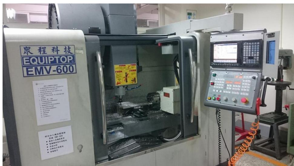
圖 3.1.1 工廠使用 CNC 綜合加工機
